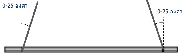
รูปที่ 36 แสดงการยกแผ่นพื้นคอนกรีตฯที่ถูกต้อง
